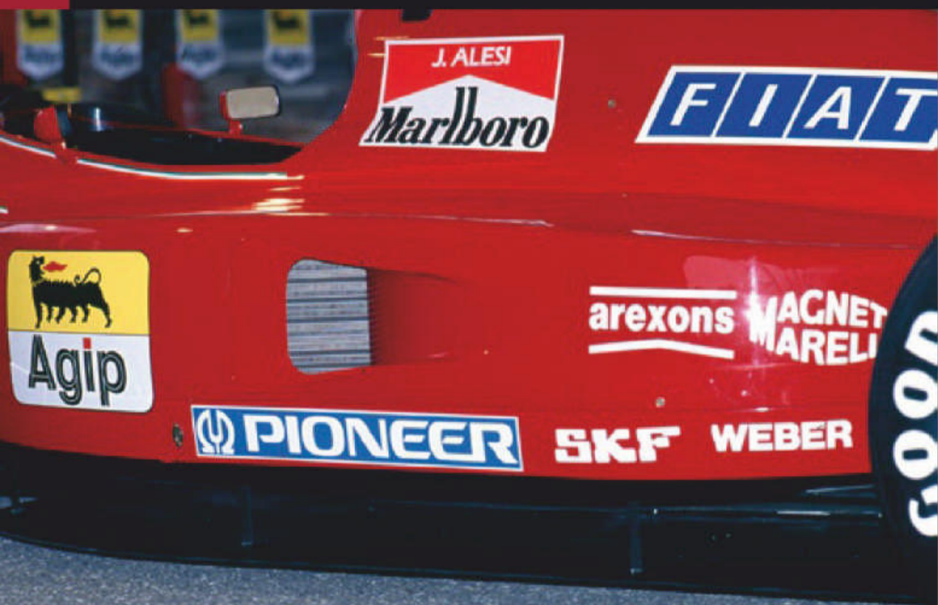
想定どおりにダブルフロアが機能せず、サイドポンツーンの真下に設けられたチャンネル(空間)を埋めた車両(普通のフロア)でテストした実績も残っている
