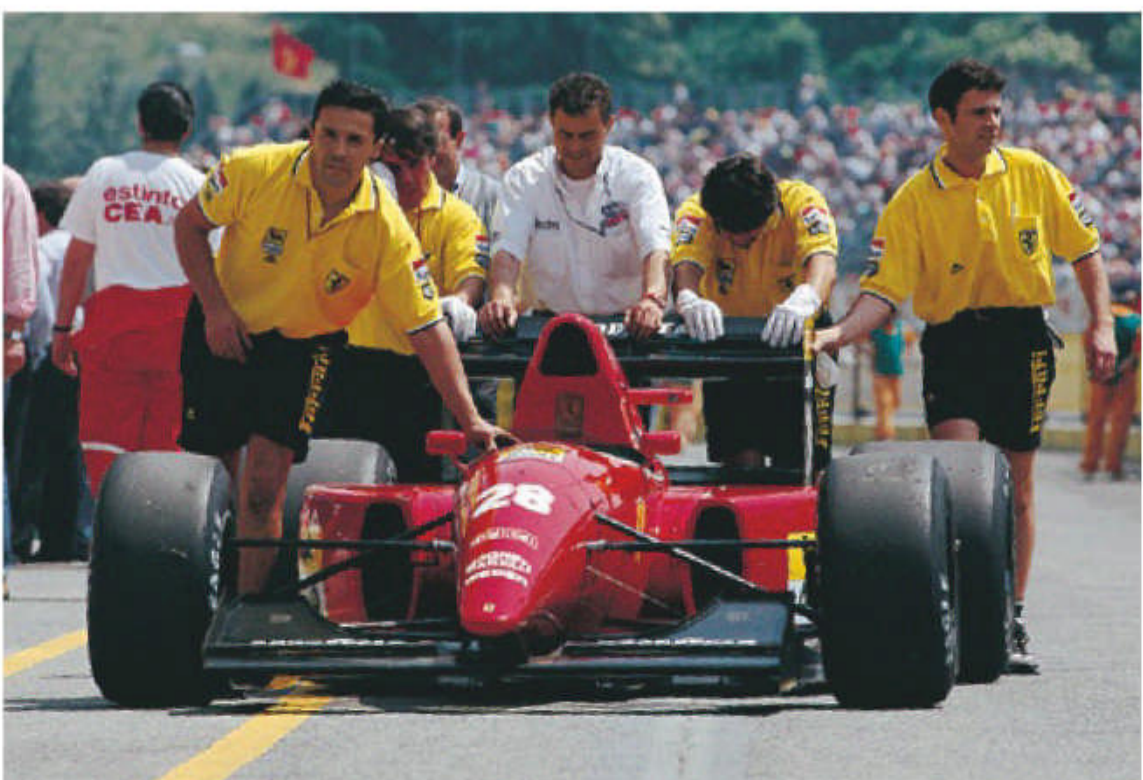
ニコルスが美しいと評したF92Aのノーズラインは、ミジョーがティレルで開発した020の流れを汲む(詳細はGP Car Story Vol.33 Tyrrell 020を参照)
