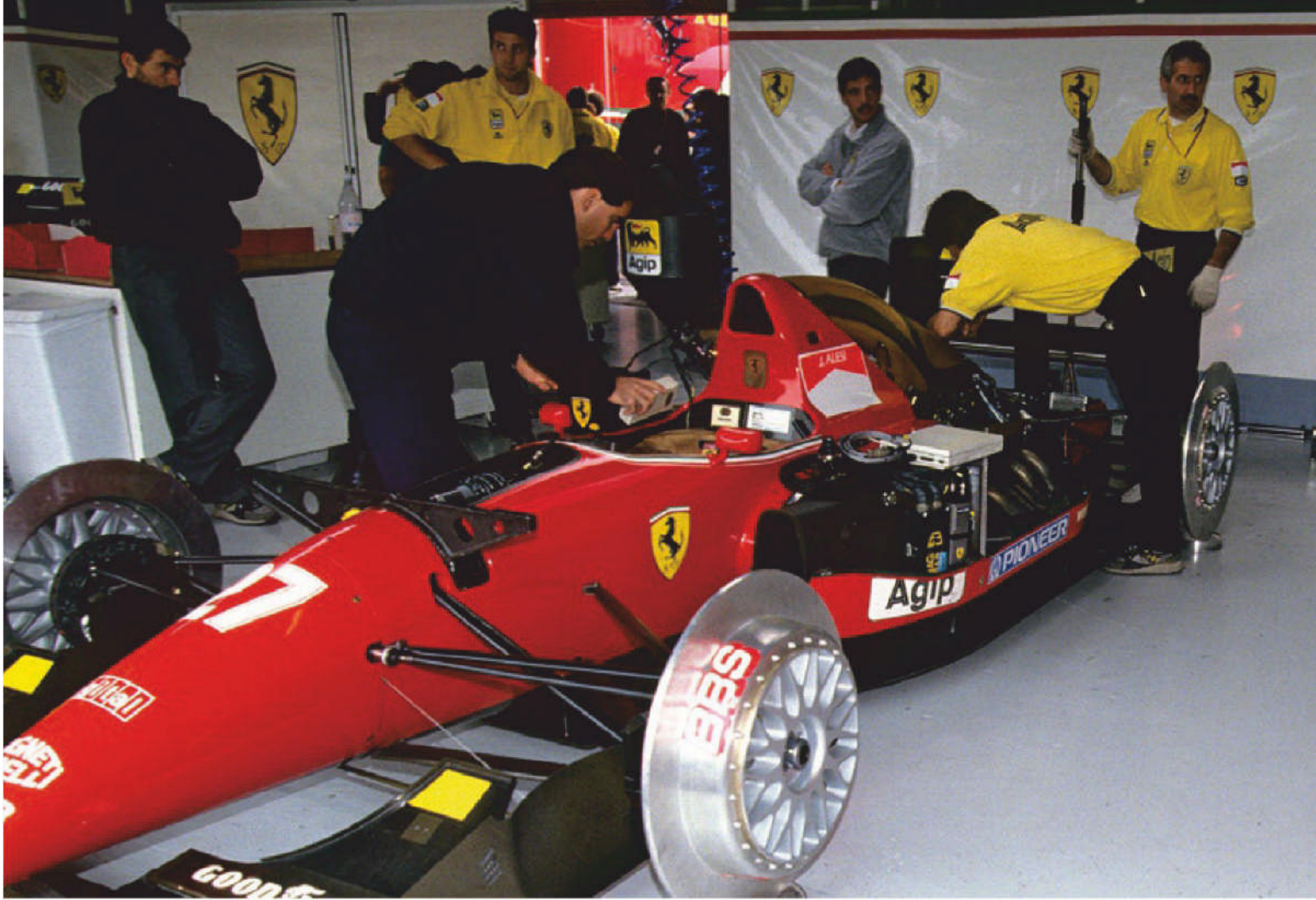
モノコックのシェイプやリヤウイング支持方法、インダクションポッド、モノショック式フロントサスから、ティレル020からの流れが見受けられる。しかしF92Aのモノショック構造は別のエンジニアが設計したという
