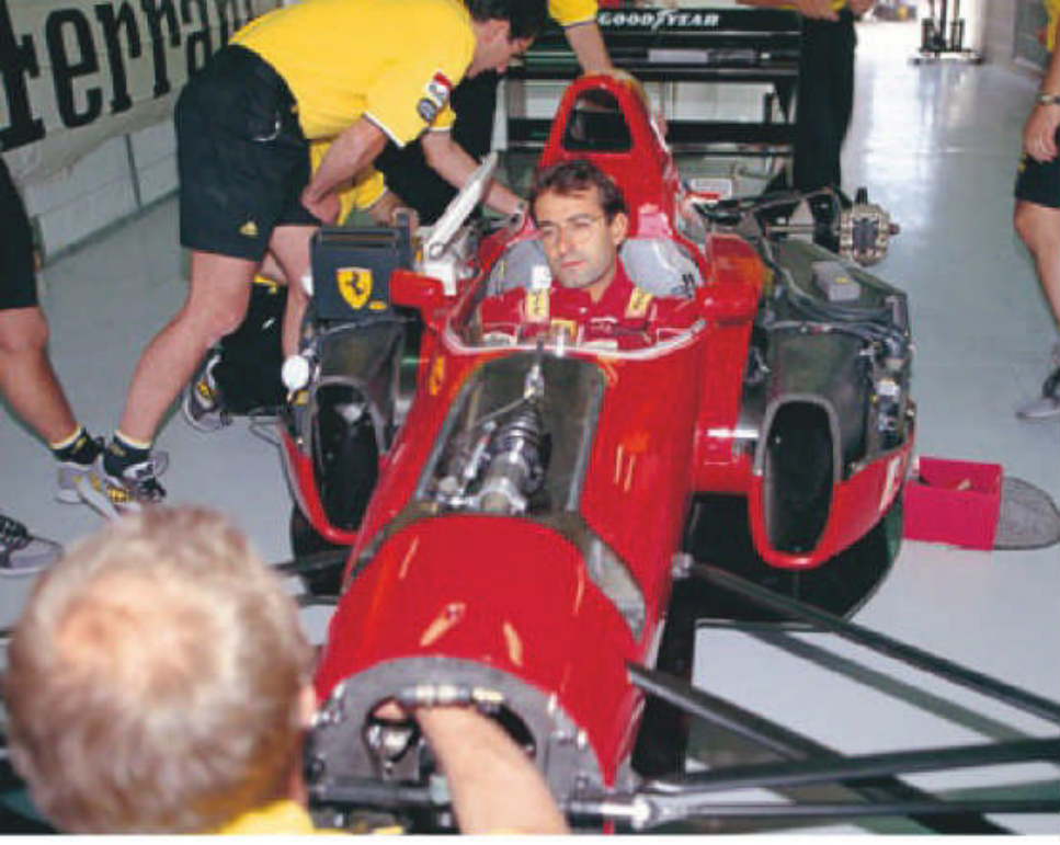
F92Aの丸いモノコックは狭く、体格の良いカペリには窮屈。快適でないマシンで走らねばならなかった
