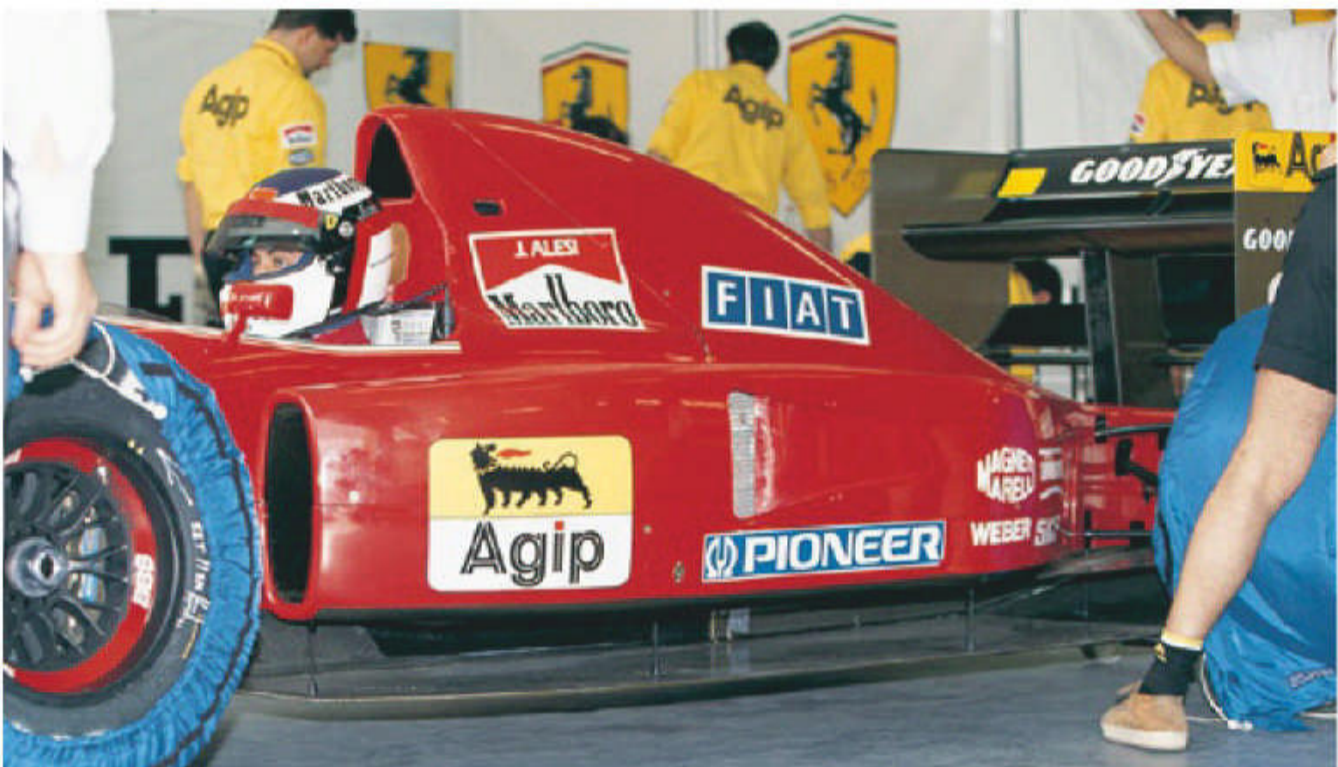
(写真上) 640からヒントを得てデザインされたというニコルスの言葉どおり、F92Aにも細い縦長のラジエターインレットが採用された。(写真下) 深さ100mmのチャンネルをコークリンまでつなげる、この空気の通り道(流路)こそダブルフロアが持つ利点だった
